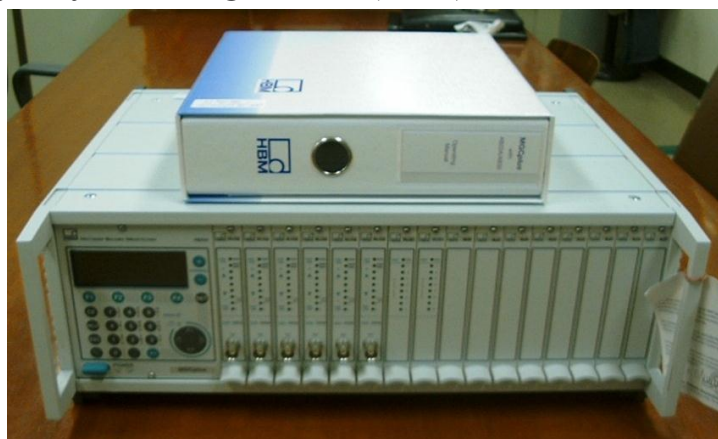
Hình 4.4. Máy đo động đa năng MGC-Plus
