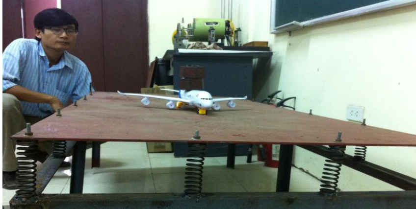
Hình 4.9. Tiến hành thí nghiệm trên tấm với tấm liên kết đàn hồi
